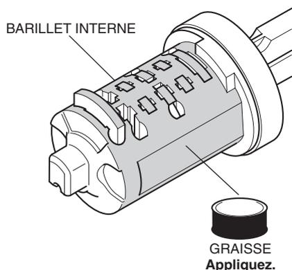
23. Montez le barillet interne en faisant glisser le contrepoids de butée le long du guide d'insertion tout en le faisant tourner.
