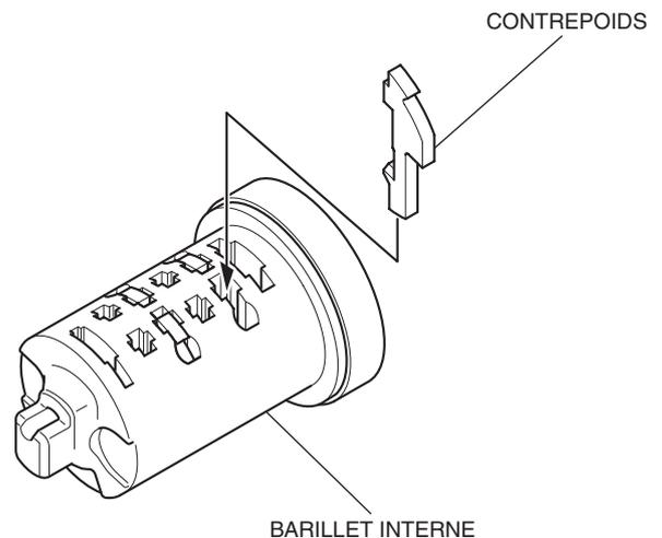
12. Répétez les étapes 7 à 11 en insérant différents contrepoids aux emplacements marqués jusqu'à ce qu'aucun contrepoids ne soit saillant.
